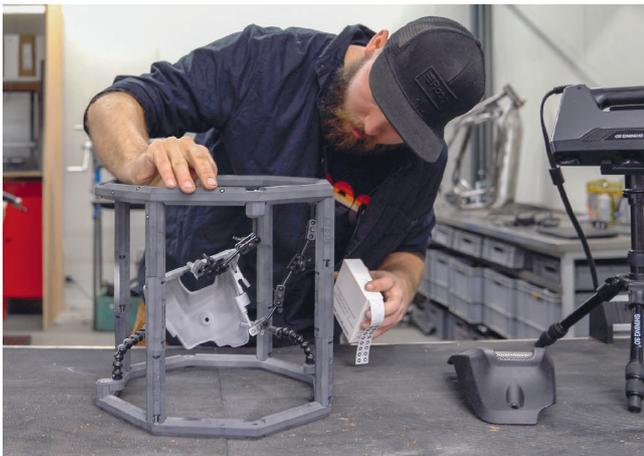
**Die Referenzpunkte 'Aesub Dots'** werden auf dem Rahmen platziert. Dadurch müssen die Bauteile nicht beklebt werden
